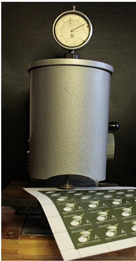
il. 4. Fabryczny, laboratoryjny przyrząd do mierzenia grubości papieru.
