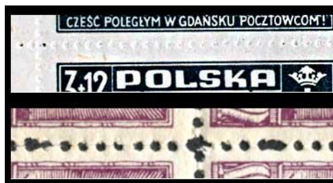
il.6. efekt zbyt małego (u góry) i zbyt dużego (na dole) nacisku.
