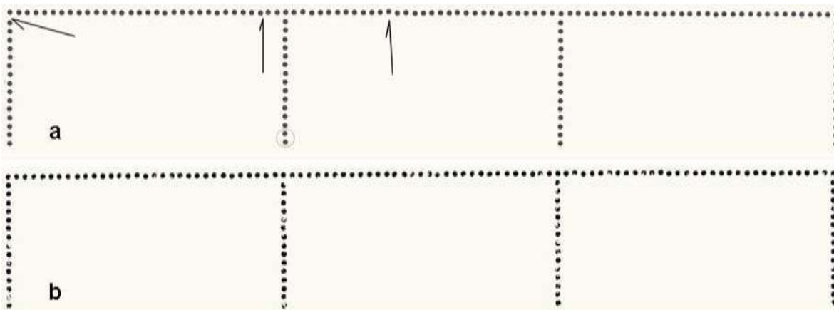
il. 6 – różnice pomiędzy grzebieniem „a” oraz „b”. Niektóre różnice w układzie igieł. Ponadto, w zestawie „b” albo: gniazda lub igły były stępione, albo perforowano jednocześnie przez kilka arkusików.
